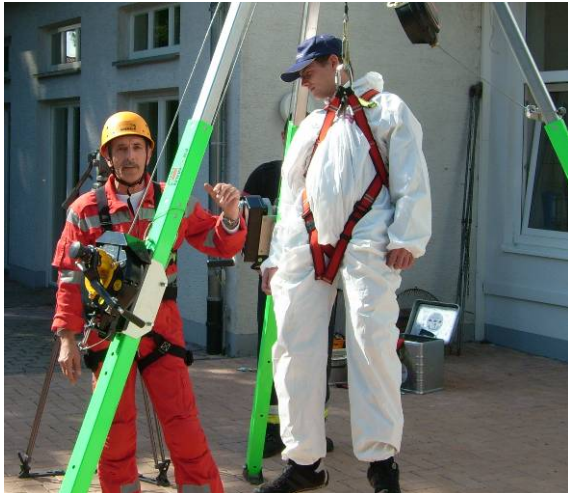
PSA: Test am Dreibock für den richtigen Sitz der Gurte
